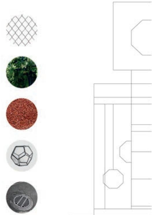
Ausstattung von oben nach unten: Einhausung Diagonalgeflecht, Bepflanzung mit Kletter- und Hängepflanzen, Boden eingefärbtes Gummigranulat, fixer Spielball aus Gerüststangen, Entwässerung in vorhandene Kanalisation
