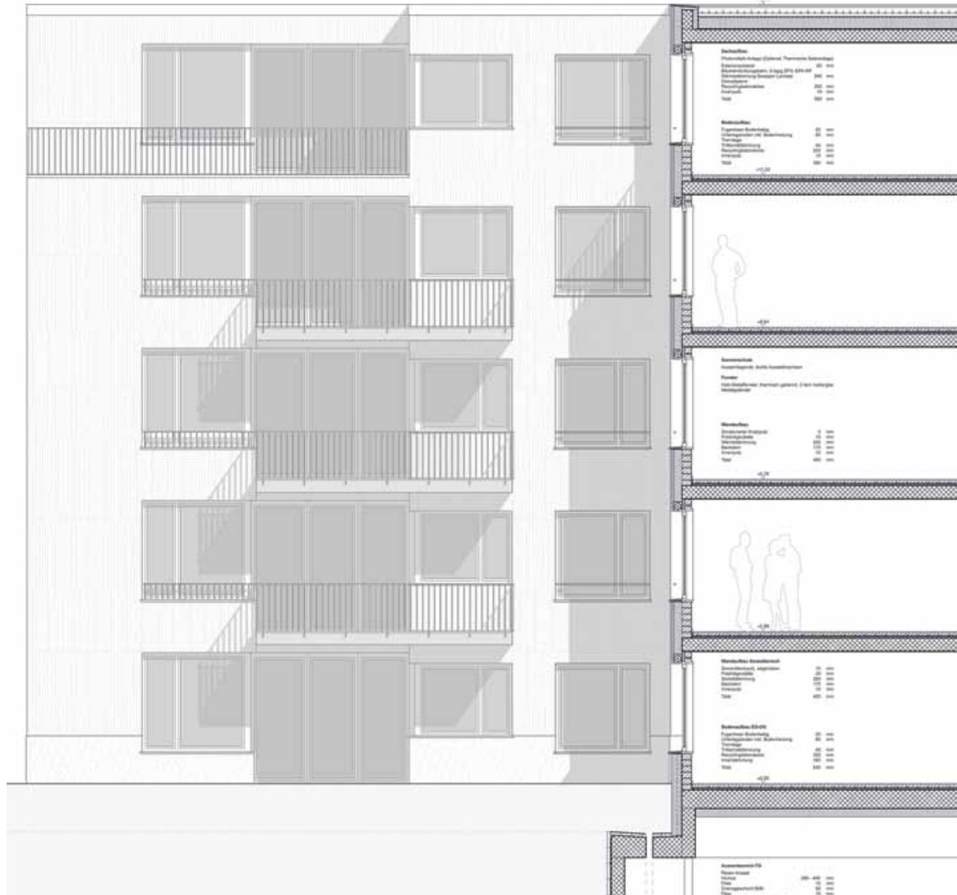
Detailschnitt Fassade 1:100
