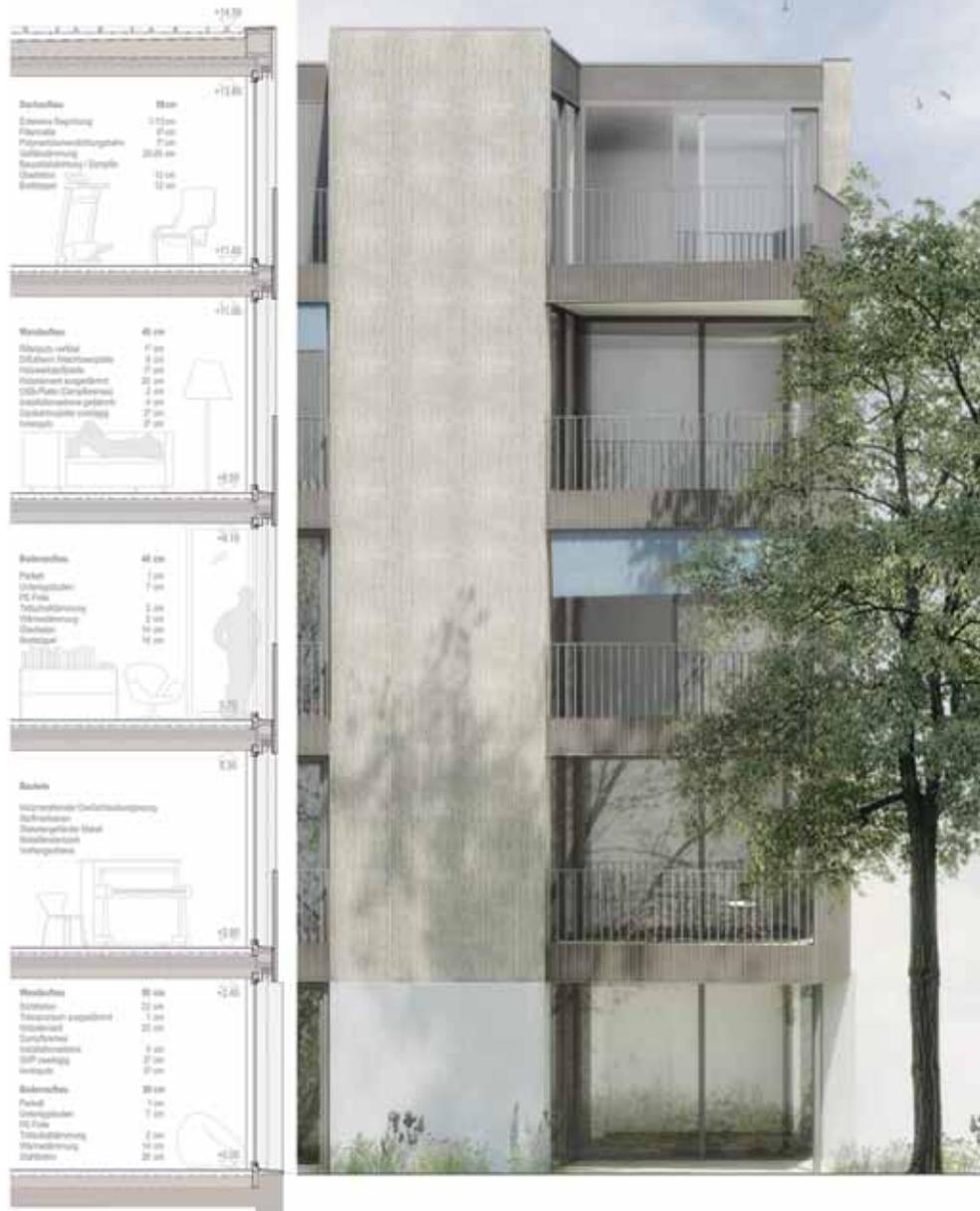
Detailschnitt Fassade 1:100
